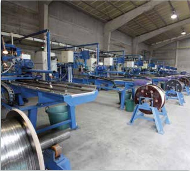
Die OPTIMA-Spaltsiebfamilie wird auf eigenen, speziell entwickelten Schweißautomaten gefertigt. Dies erfolgt sowohl im Rundwickel- als auch im Planschweißverfahren.
