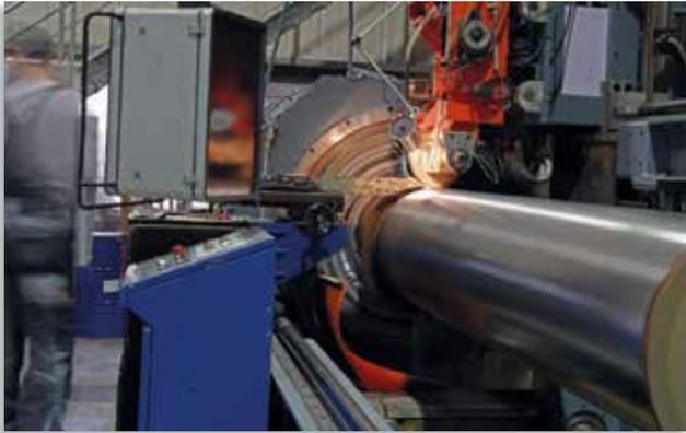
OPTIMA Spiralzylinder werden bis zu einem Durchmesser von 1.022 mm und einer Länge von 5.500 mm gefertigt. OPTIMA Präzisionsfilter decken mit hochpräzisen Schweißautomaten hingegen einen Bereich der Durchmesser von 23 mm bis 305 mm ab.
