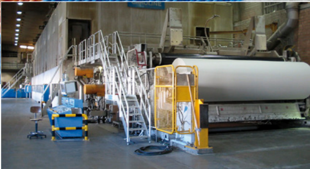
Moderne Papiermaschine mit Rodewisch-Trockensieben
