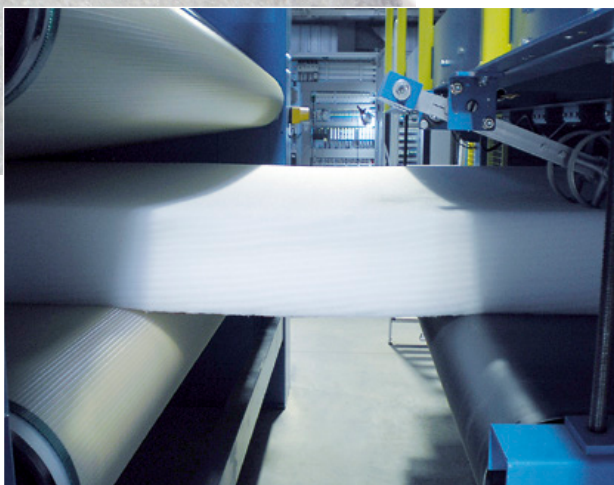
Hochtemperaturbeständige Siebe in einer Thermobonding-Anlage
