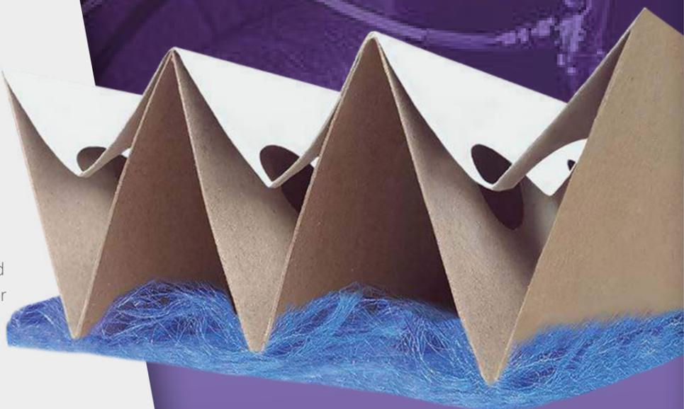
Der Filter Andrea Original HH bietet eine höhere Filtrationseffizienz mit reduziertem Druckverlust. Sein langes Leben in der Kabine reduziert die Wartungskosten. Er besteht aus zwei robust und wiederverwerteten „kraft“ Kartonwänden, perforiert, gefaltet und miteinander verklebt. Die Zugabe einer dünnen Glasfaserschicht an der Rückseite des Filters verleiht dem HH einen hohen Filtrationswirkungsgrad und eine hohe Belastbarkeit.
