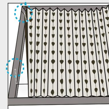
① Setzen Sie zwei gerade Zinken hinter dem Filtrerrahmen ein. (Der gezeigte Rahmen zeigt eine Zellenöffnung in einer vorhandenen Abluftbank der Spritzkabine.) Die geraden Zinken verlaufen vertikal auf und ab, können jedoch horizontal positioniert werden.
