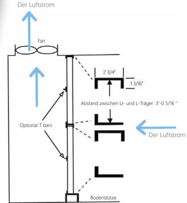
Andreae-Filter werden von einem umgekehrten U-Träger oben und einem L-Träger unten gehalten. Wenn die Kabine mehrere Filterreihen hat, wird jede Reihe über dem angrenzenden Träger installiert.
