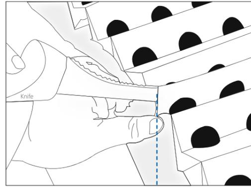
Sie schneiden zwei Papierschichten durch (plus Synthetikmaterial im High-Bereich). Drücken Sie die Falten auf beiden Seiten unter dem Messer zusammen, um eine zusätzliche Kontrolle beim Schneiden zu gewährleisten.
