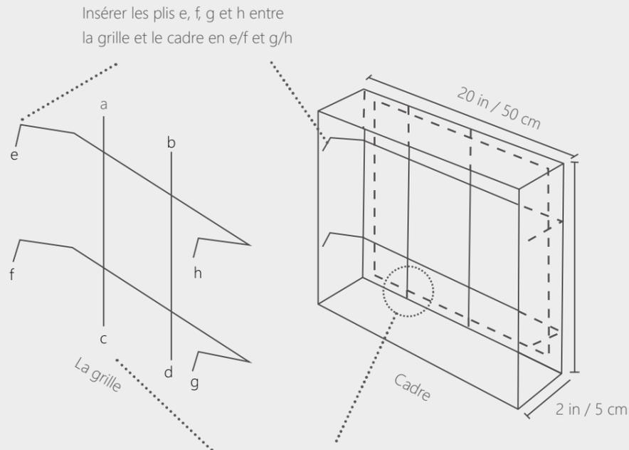
Les dents a, b, c et d vont derrière le dos du cadre pour sécuriser le support de fil pendant la dépose du filtre chargé.
