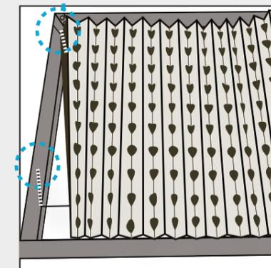
① Insérez deux dents droites derrière le cadre du filtre. (Le cadre illustré représente une ouverture de cellule dans un banc d'extraction d'une cabine de pulvérisation existante). Les dents droites fonctionnent verticalement, de haut en bas, mais peuvent être positionnées horizontalement.
